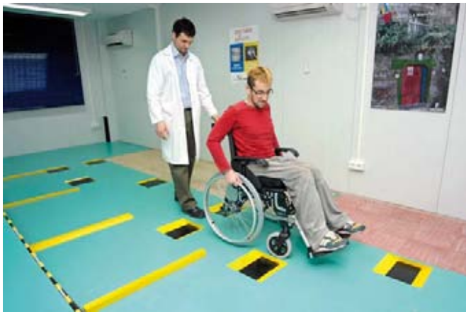
Ensayo de maniobrabilidad.
