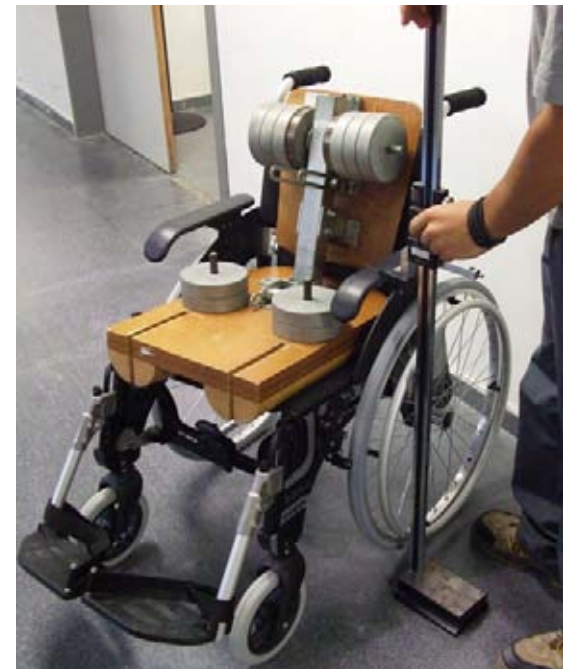
Ensayo de adecuación dimensional.
