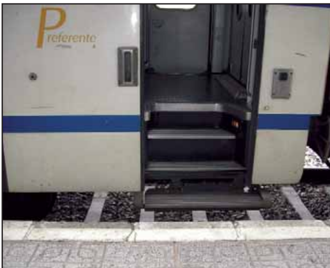
Muestra de la altura que tiene que salvar una personas con movilidad reducida para poder subir a un tren.
